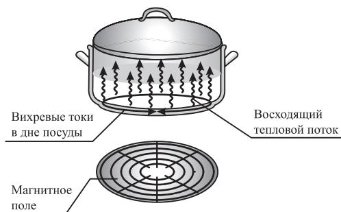
Принцип работы индукционной плиты основан на индукционном нагреве, который представляет из себя нагрев тела в электромагнитном поле за счет теплового действия вихревых электрических токов, протекающих по нагреваемому телу и возбуждаемых в нем благодаря закону электромагнитной индукции.
