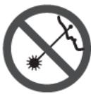
Не направляйте лазерный луч на людей или животных и не смотрите сами в лазерный луч. Настоящий измерительный инструмент создает лазерное излучение класса 2 согласно IEC 60825-1. Этим излучением Вы можете непреднамеренно ослепить людей.
