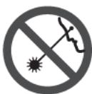
**Не направляйте промінь лазера на людей або тварин, і самі не дивіться на промінь лазера.** Цей вимірювальний прилад створює лазерне випромінювання класу 2 відповідно до норми IEC 60825-1. Цим випромінюванням можна ненавмисне заспіти інших людей.
