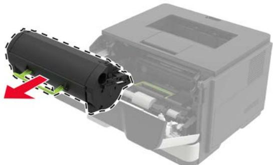
**3** Распакуйте новый картридж с тонером, а затем три раза встряхните его, чтобы распределить тонер внутри.
